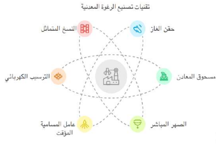
شكل (4) اهم تقنيات تصنيع الرغوة المعدنية
