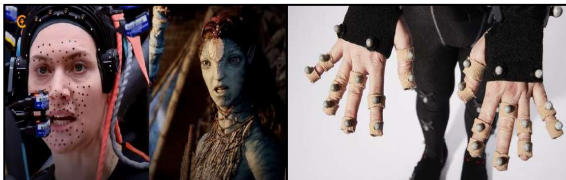
صورة (١٣) توضح لاقط الحركة (Motion Capture)
