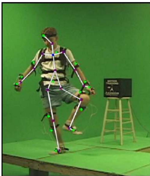
صورة (١٥) توضح لاقط الحركة المغناطيسي.
