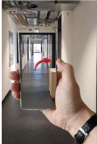
شكل ( ٢ ) استخدام تقنية الواقع المعزز في الملاحة الداخلية للتنقل باستخدام الأجهزة المحمولة من خلال رموز الأسهم المتراكبة (١٧)
