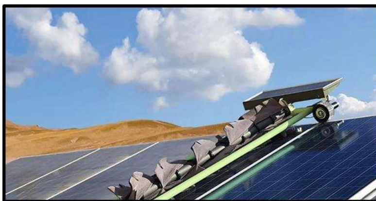
شكل ( 6 ) يوضح تصميم روبوت يعمل بتقنيات الذكاء الاصطناعي لتنظيف الخلية الشمسية بمحطة الطاقة الشمسية لزيادة فاعليتها
