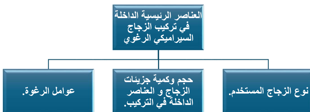
الشكل التوضيحي 3 مخطط يوضح العناصر الرئيسية الداخلة في تركيب الزجاج السيراميكي الرغوي
