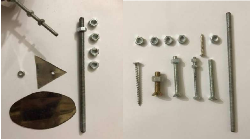
شكل (٢١) أشكال متنوعة من البراغي والأسياخ المقلوطة والصواميل وقطع معدنية مثقوبة تجهيزاً لتجميعها بالبراغي والصواميل
