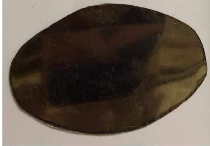
شكل (٢٠) قطعة معدن تم تشكيلها بالقص بالمقص المعدني (القص بالمقص)
