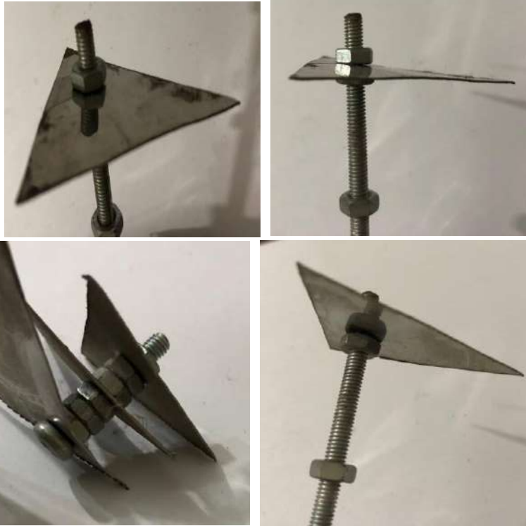
شكل ( ٢٢ ) يوضح وصل قطعة معدنية بالبراغي والصواميل وتجميع أكثر من قطعة معدنية وكيفية العمل علي تنوع المسافات البينية بالصواميل (تصوير الباحثة)
