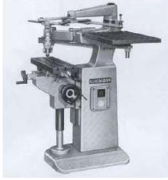
شكل (٢) جهاز البانتوجراف Pantograph<sup>١٠</sup>
