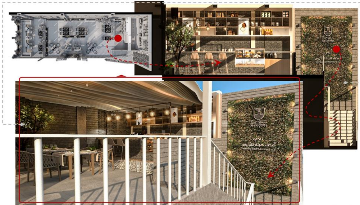
شكل ٣٤، تصميم حائط منطقة الدرج الخارجي الموصل للمدخل الفرعي للمبنى ومنطقة الكاونتر الذي تم تدعيمه بتصميم من الرخام للوجو جامعة الاسكندرية واسم النادي - (الباحثة)
