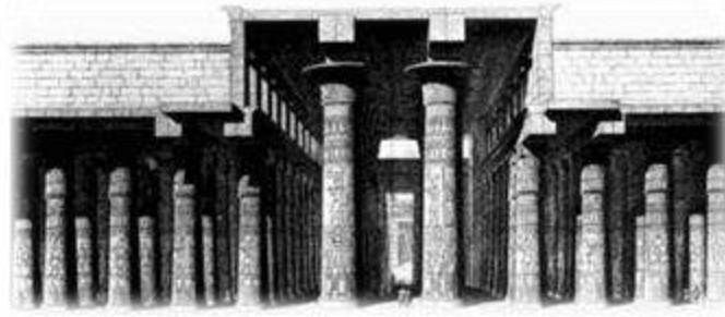
شكل رقم (٧) يوضح استخدام فرق مناسيب الأسقف لتوزيع الإضاءة – معبد آمون
