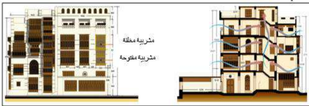
الشكل ٦. يوضح الجانب الوظيفي للمشربية: الحماية من أشعة الشمس، وتنظيم الإضاءة، وتقليل ضوء الشمس، والتهوية.
