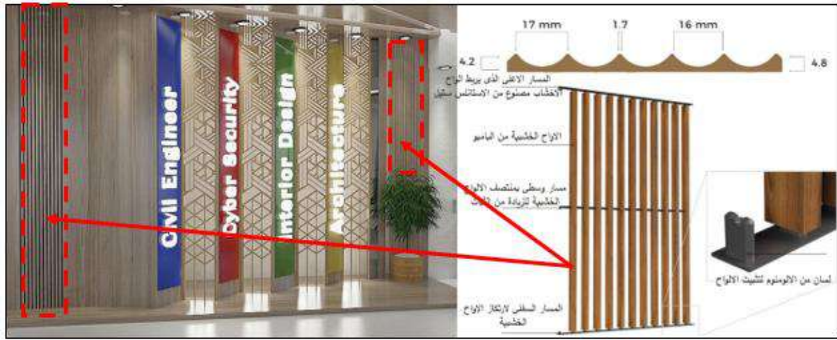
الشكل ٢٣. يوضح تصميم القواطع والتجاليد الخشبية المستوحاه من الشكل الهندسي المثلث مع الجزء التعريفى للاقسام باستخدام الاكربليك الملون.
