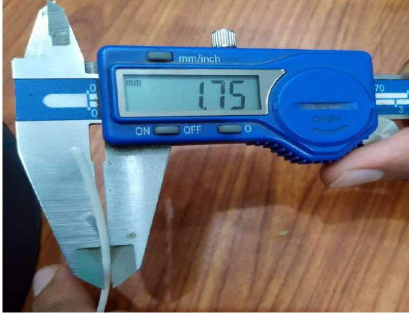
شكل (٩) يوضح سُمك الخيوط باستخدام القدمة ذات الورنية
