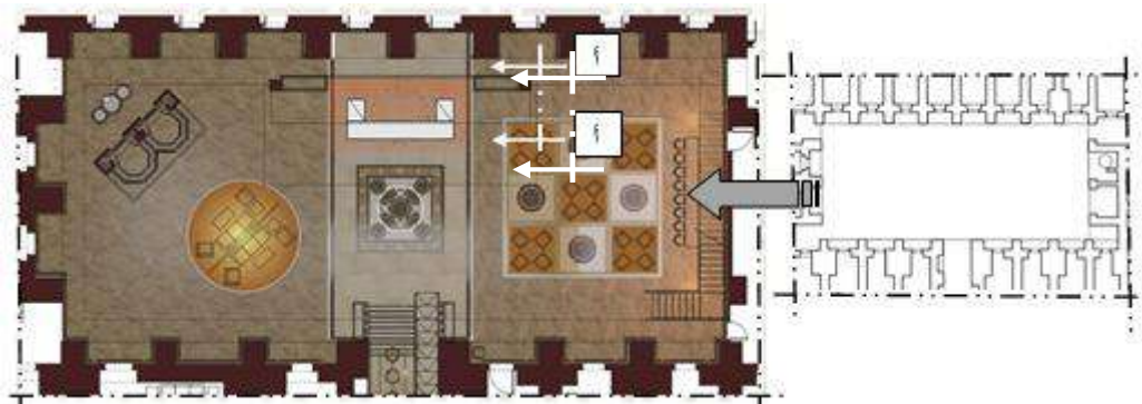
(شكل ١٨) مسقط افقى لمنطقة اللوبي بالدور الارضى بالمبنى الأثرى (يميناً)، و التصميم المقترح للمسقط الافقى (يساراً) و يضم تصميم كاونتر الاستقبال و مناطق الجلوس و حيز كافيتريا المدخل، بالإضافة لتصميم الارضيات.
