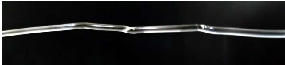
شكل (٧) يوضح عدم انتظام سمك خيوط البلاستيك
