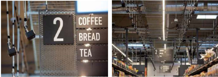
صور (١٦) توضح الكاميرات وأجهزة الاستشعار المثبتة بالسقف وبالقرب من الأرفف
