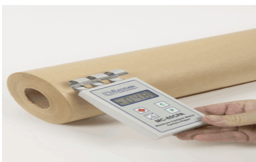
شكل (٢) جهاز Moisture Meter لقياس نسبة رطوبة الورق
