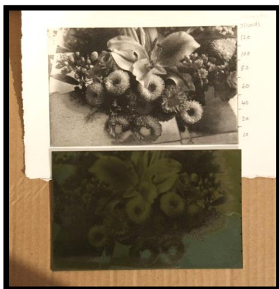
شكل (٦) القالب الطباعي وعليه فيلم الفوتو بوليمر بعد التعريض والإظهار، والنسخة الطباعية بعد الطباعة. ٢
