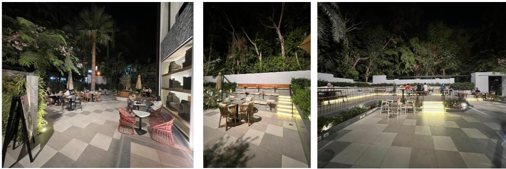
شكل (٢٣) يوضح الإضاءة ليلاً بمنطقة الحديقة متوسطة تعتمد على إضاءة كشافات على المبنى موجهة على الحديقة و إضاءات شرائط LED للسلالم و الأشجار- بعد التعديل .
