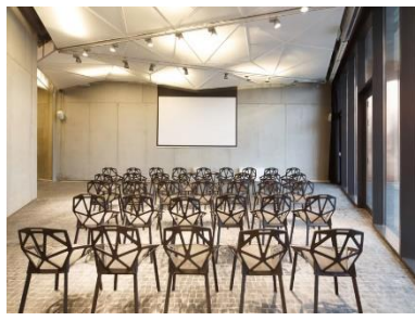
صورة (٢١) التصميم الداخلي لأحد قاعات العرض ، وانعكاس تقنية الطي على تشكيل الأسقف باستخدام الألواح المطوية، كما يظهر التشكيل بتقنية الطي في تصميم الأثاث واضحاً في ظهر الكراسي الموجودة داخل القاعة.
