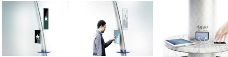
صور رقم (١٨) صورة توضيحية لأحد المستخدمين، يستخدم التطبيقات المتوفرة "smart Palm" وذلك عن طريق الشاشات الذكية المتوفرة والمثبتة على النخلة من الجهتين، وشحن الأجهزة المحمولة.
