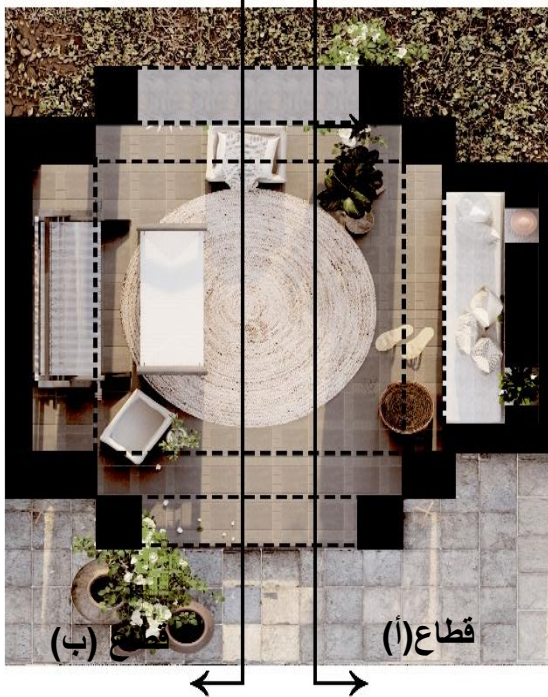
صور رقم (١٩) توضح القطاع الأفقي (البلان) لتصميم إحدى ورش النسيج بمقياس رسم (٥٠:١)
