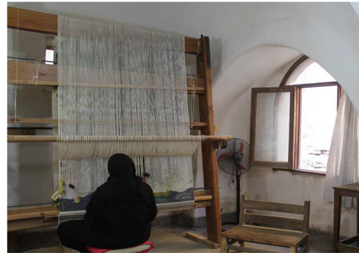
صورة رقم (٨) توضح النول الرأسي المستخدم لإنتاج الكليم اليدوي بمركز رمسيس وصيا واصف
