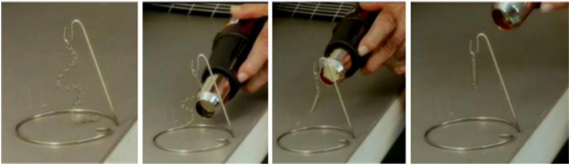
شكل ٢: يوضح كيفية إعادة شكل لولبي ياي مكون من سبيكة ذاكرة شكل إلى شكله الأصلي بالتسخين
