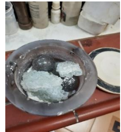
شكل رقم (٤) يوضح كسر الزجاج في مطحنة الزجاج قبل تشغيلها
