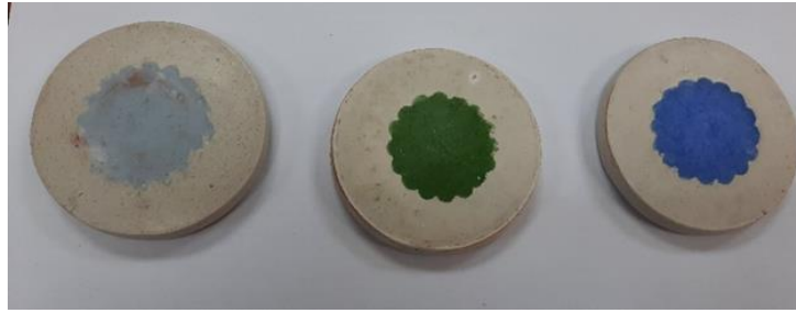
شكل ( ٢١ ) يوضح العينات بعد المعالجة الحرارية باستخدام قالب دائري وقالب على شكل وردة في المنتصف
