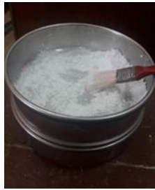
شكل رقم (٦) يوضح نخل بودرة الزجاج
