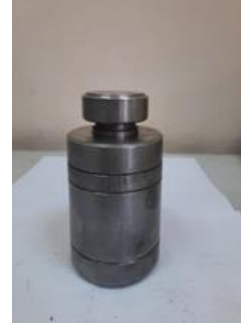
شكل رقم ( ٨ ) قالب حديدي دائري الشكل المستخدم في كبس العينات
