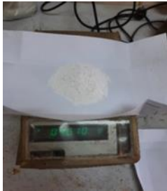
شكل رقم (٧) يوضح وزن ٤٠ جرام من بودرة الزجاج
