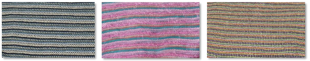
التصميم الأول التصميم الثاني التصميم الثالث شكل (١٩) يوضح صور فوتوغرافية للقماش (التصميمات) الناتج من تركيب دبل بيكه.
