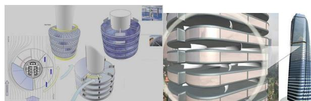
شكل (١٧) يوضح التوربينات الهوائية وطريقة تثبيتها
