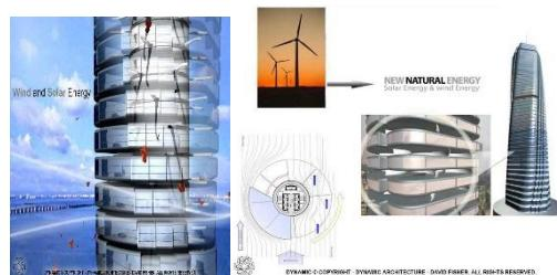
شكل (٤) يوضح استخدام توربينات الرياح في المسافة البينية بين الأدوار من أجل توليد طاقة كهربائية للمبني
