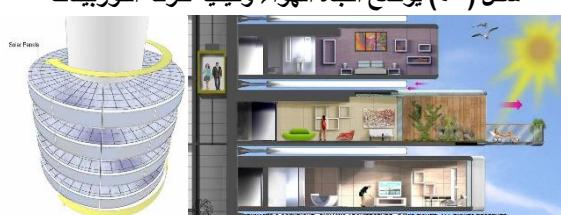
شكل (٤) يوضح استخدام الطاقة الشمسية في توليد الكهرباء عن طريق الخلايا الكهروضوئية على أسطح أدوار المبني بالإضافة إلى استخدامها في الإضاءة الطبيعية والحمامات الشمسية
