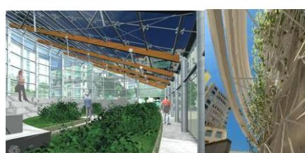
شكل (٤) يوضح استخدام المساحات الخضراء من أجل تحقيق الراحة الحرارية داخل المبني
