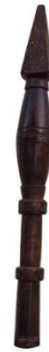
صورة (١٥) توضح مدقة المهباش، وتصنع من خشب البلوط أو السنديان وأحياناً من المشمش، ويجب أن لا تكون نفس خشب البدن حتى لا تؤثر على قاع المهباش أثناء الدق
