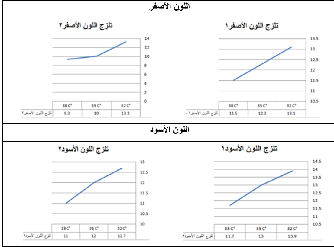
شكل رقم (٥): قيم التلزوج للأحبار التشغيلية عند ارتفاع تأثير ارتفاع درجة الحرارة (٣٢° ، ٣٥° ، ٣٨°).
