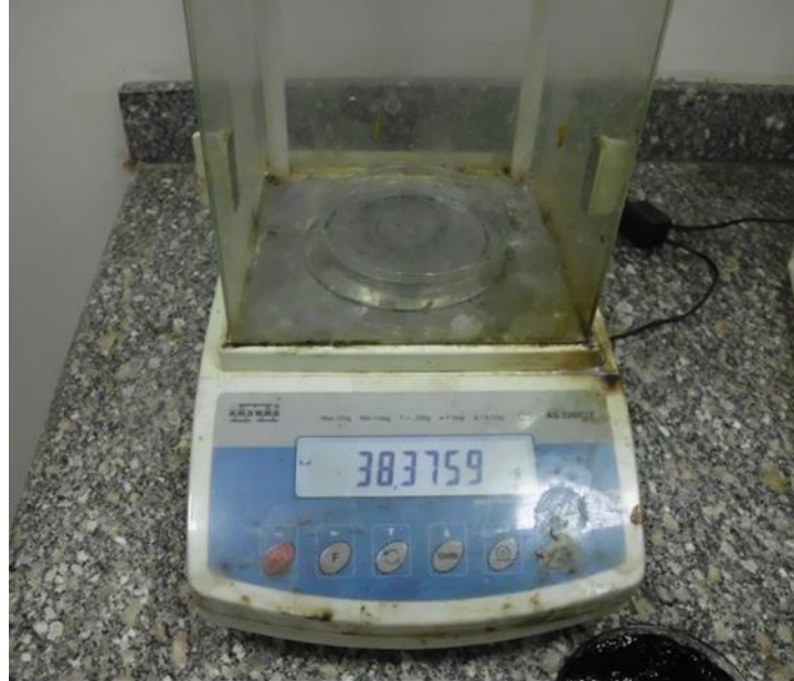
صورة رقم (٣) توضح عملية قياس الوعاء الزجاجي قبل وضع عينة الفوتوبوليمر غير المتصلب فيها
