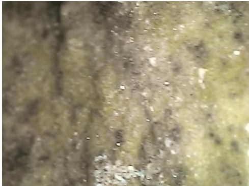
صورة لأنية فخارية وتبين من خلال الميكروسكوب بقوة تكبير (45x) وجود طبقة متكلسة ربما تكون ملحية ومتداخلة مع الاتساخات في ظل الرطوبة المرتفعة فتكونت الطبقة الصلبة شديدة الالتصاق بسطح الانية
