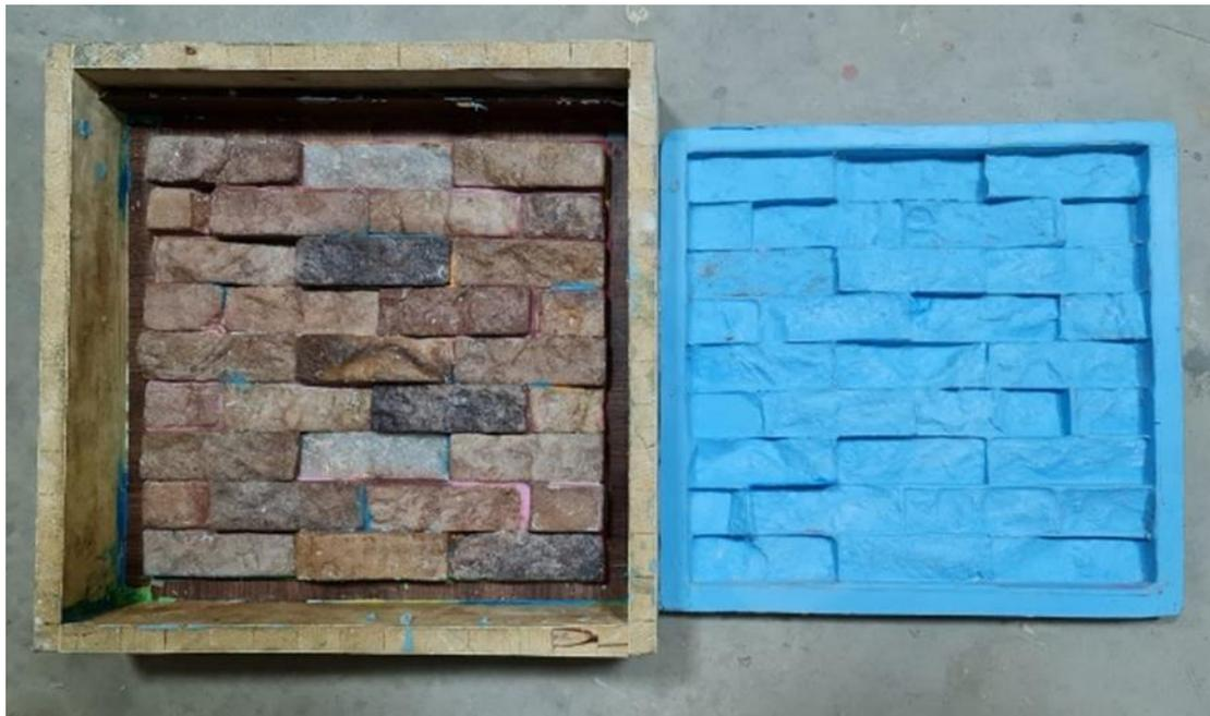
شكل (٢٣) التصميم الاصلي المعد لصنع القالب ، وشكل القالب بعد التنفيذ.
