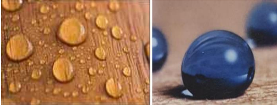
الشكل رقم ( ١٥ ) يوضح سطح الخشب المعالج بطبقة من طلاء النانو الطارد للمياه
