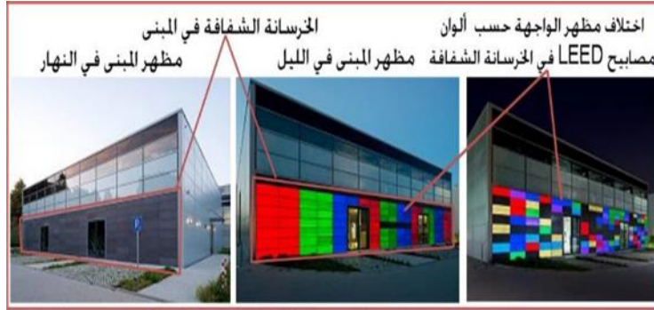
الشكل رقم ( ٥ ) يوضح استخدام الخرسانة الشفافة في مبنى معهد أبحاث النسيج بألمانيا
