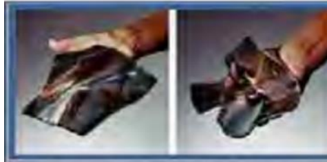
الشكل رقم ( ٤ ) يوضح المطاط المعدنى ذو مرونة عالية
