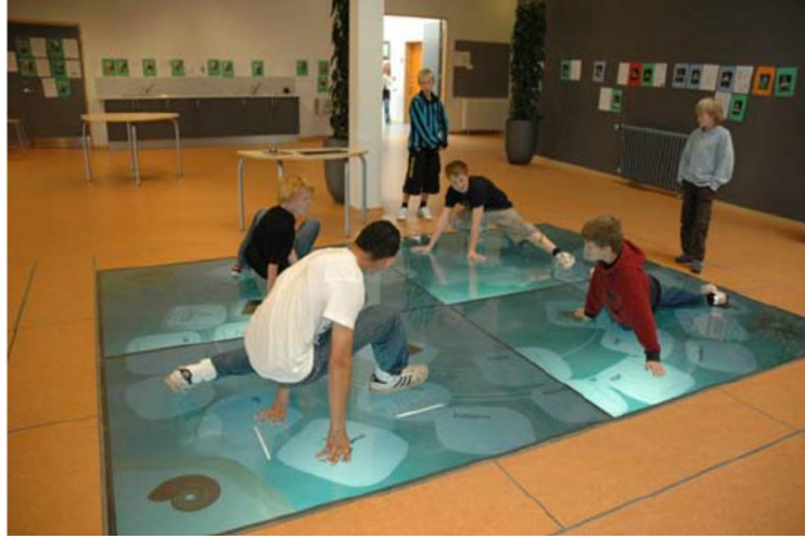
صوره (٥) توضح الأرضيات التفاعلية المستندة إلى الاستشعار الميكانيكية
