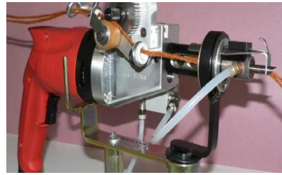
صورة (١) توضح مسدس التافت المستخدم في انتاج السجاد نصف الآلي- نقلاً عن
