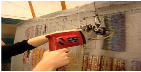
صورة (٢) توضح طريقة غرز الوبره لانتاج السجاد نصف الآلي - نقلاً عن
