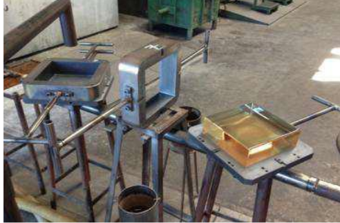
شكل رقم (٤) : طريقة تصنيع أثاث الحدائق والمنتزهات من ألياف الموز وألياف الزجاج المدعمة بالإيبوكسى على النقاء يشابه الطريقة المستخدمة فى تصنيع الطوب الزجاجى
