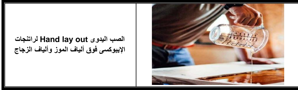
شكل رقم (٦) : طريقة الصب اليدوي Hand lay out المستخدمة في عمل العينات
