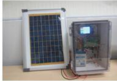
الشكل (٣) منظر خارجي لعقدة الاستشعار (مصفوفة المستشعرات) مع اللوح الشمسية، مع العلم بأن اللوح الشمسي سيتم توصيله ضمن أقرب فتحة معمارية (نافذة).
