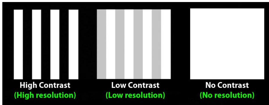
شكل (٧) العلاقة بين قوة تحديد العدسة resolution وقدرتها على نقل التباين contrast
