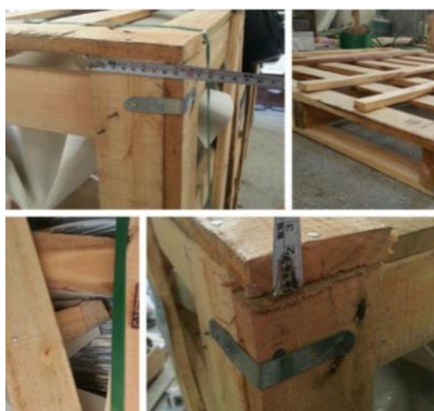
صورة(38): الأقفاص الخشبية لتغليف أجزاء المحاريب. المصدر: 58
