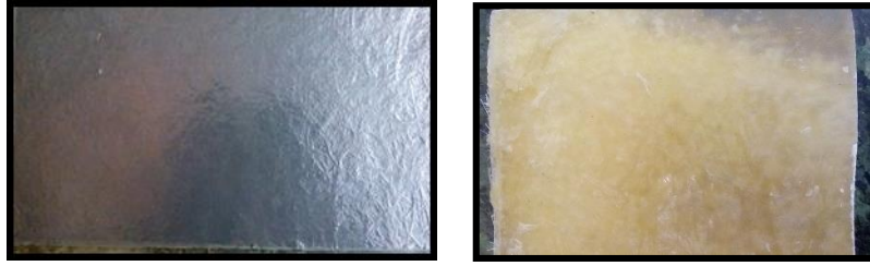
شكل ( ١ - ٥ ) : شكل العينات التي تم إنتاجها بطريقة الصب اليدوي لسوائل البولي إستر المكوبلت مدعوماً بالألياف الزجاج غير المنسوجة
