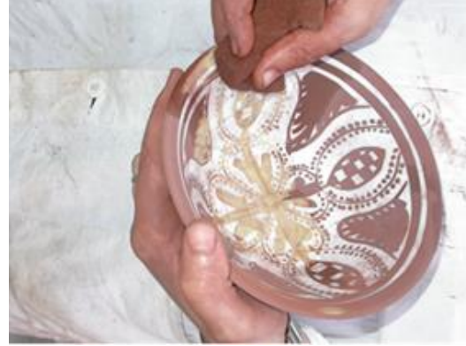
شكل رقم (12) إزالة الطبقة الطينية بعد عملة الاختزال ويظهر من تحتها ألوان البريق المعدني الذهبية
