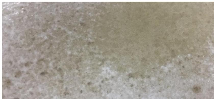
بلاطة حوائط مطبق عليها يطانه وطلاء ابيض مطفيء خاص بالمصنع محروق ثم طبق عليها الصمغ بالرش ثم الملح بالنثر
