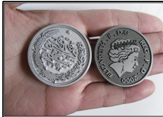
شكل (20) الإسطمبه بعد نقل حجمها الي حجم العملة الحقيقي على قالب من الفولاذ
