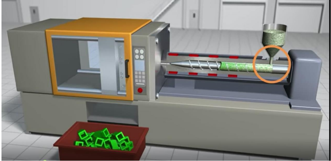
(8-1) في حالة التشكيل بالقولبة توضع الخامة في الوعاء المخروطي (الى اليمين) حيث تتدفق منه الى الأسطوانة الافقية التي توجد تحته و تحوى داخلها على مصهر حراري
