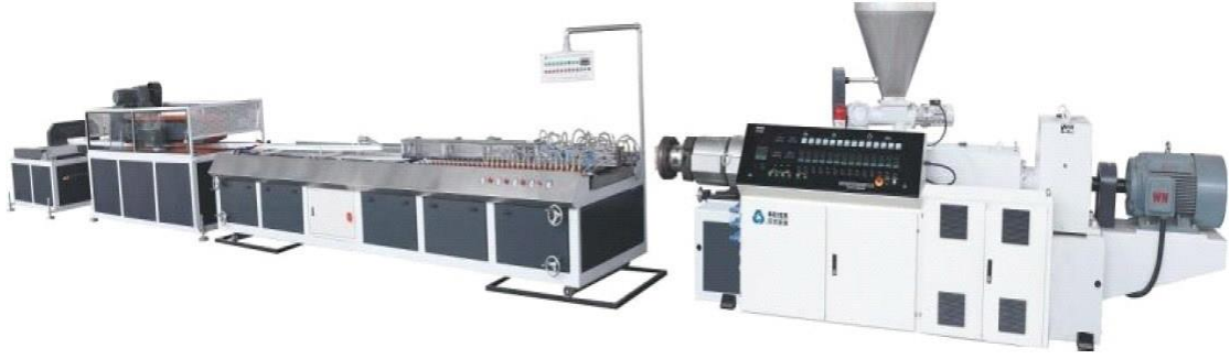
(6-1) صورة توضح خط الانتاج الذى يستخدم المادة الناتجة عن صهر الحبيبات ويحولها الى المنتج النهائي وفقا لأسلوب التشكيل المراد سواء القولبة او سحب الالواح البلاستيكية ( يتم تفصيله في الاشكال اللاحقة)
