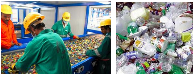
(3-1) في الصورة الى اليمين يظهر شكل الحاويات البلاستيكية المصنعة من البروبيلين المراد اعادة استخدامها قبل دخولها الى كسارة البروبيلين ، والصورة الى اليسار يظهر البروبيلين بعد فرمه و تحوله الى كتل صغيرة تمهيدا لوضعه في الخلاط.
