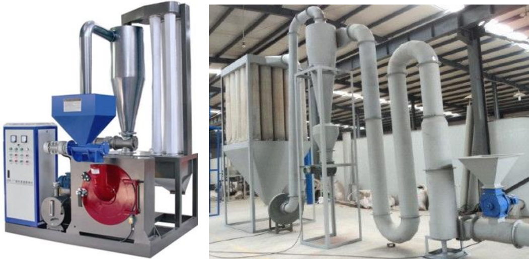
(1-1) يظهر الى اليمين المطحنة الخاصة بتنعيم الجزيئات الخشبية الى المقاس المطلوب و الى اليسار المجفف الى يصل بالنشارة الى درجة الجفاف القياسية التي تناسب عملية التصنيع .
