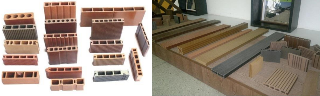
(19-1) يظهر من الصور المرونة العالية للخامة وقابليتها للتشغيل والتشكيل عن طريق القولبة او سحب القطاعات وغيرها من اساليب التشكيل المختلفة .
