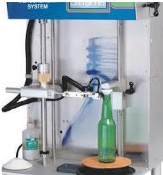
شكل (4): جهاز اختبار الحمل الرأسى على العبوات الزجاجية
