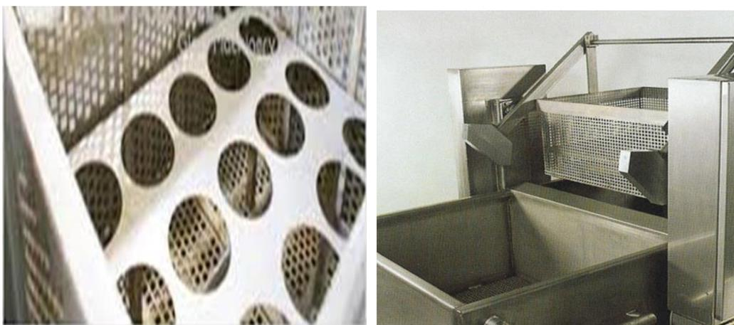
شكل (6): جهاز اختبار الصدم الحرارى (حوضين مائيين بقلاب) شكل (7): سلة من مادة خاملة بحاجز يفصل العبوات ويمنع طفوها
