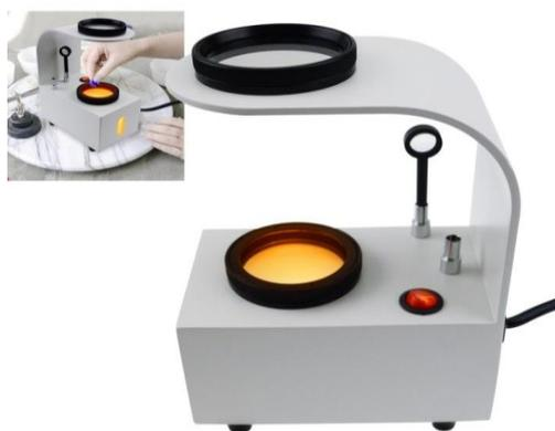
شكل (9): جهاز البولاريمتر الرقمي المستخدم لقياس الاجهادات بالعبوات الزجاجية
