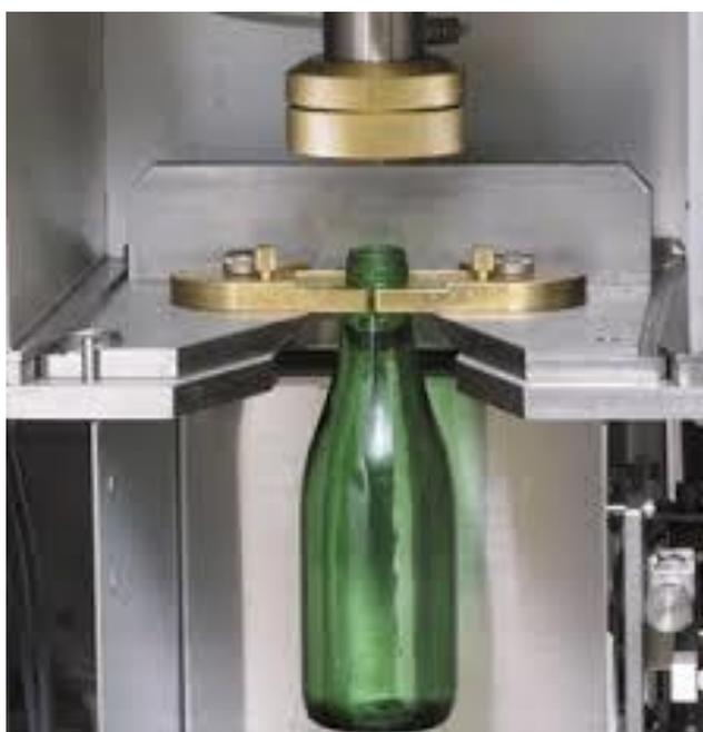
شكل (5): جهاز اختبار مقاومة الضغط الداخلي على العبوات الزجاجية
