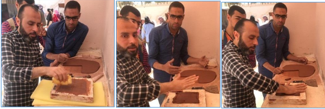
شكل (6) يوضح مراحل ضغط (كبس) الطينة داخل القالب الجصي
