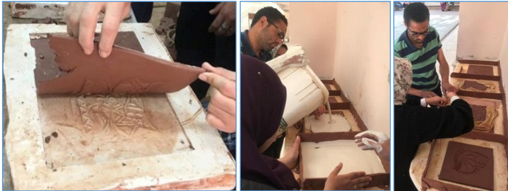
شكل (5) يوضح عمل القوالب الجصية للبلاطات
