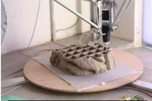
شكل 22: الطباعة ثلاثية الأبعاد لوحدة خزفية
