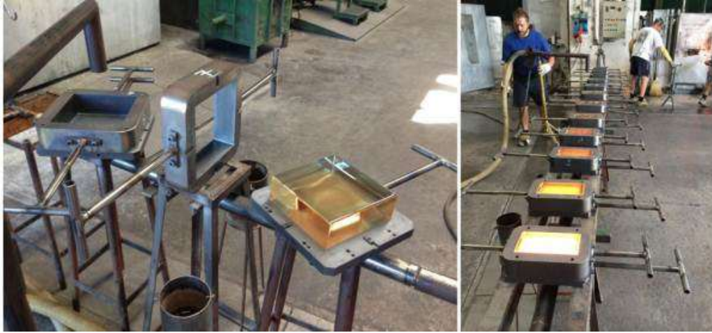
شكل (14) يوضح طريقة صب البلاطة الزجاجية المصمتة داخل القالب
