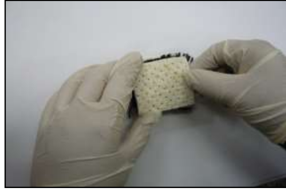
صورة (3): تحضير حامل الراتنجات المخلفة صناعيا، والمدعمة بألياف الصوف الزجاجي
