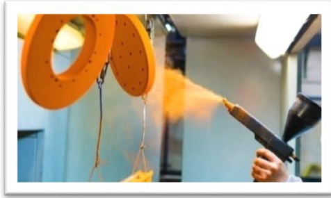
شكل (9) عملية الطلاء ببودرة البلاستيك (الكتروستاتيك)
