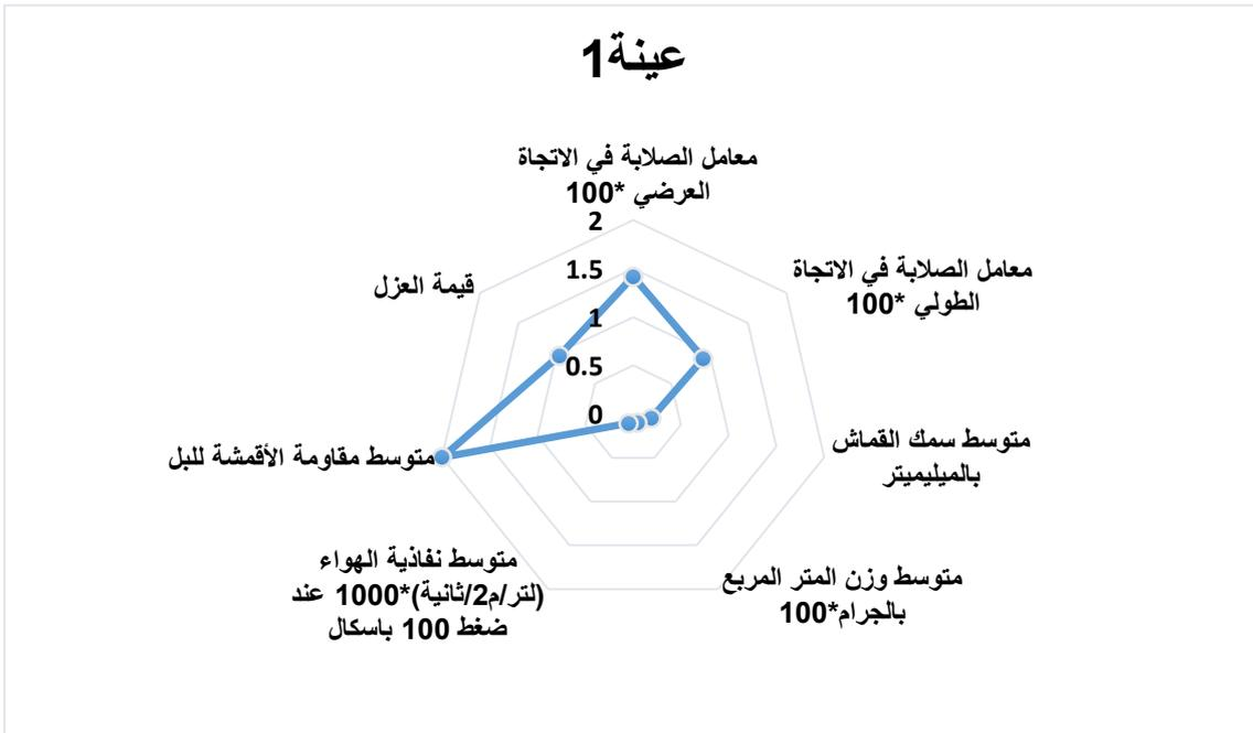
شكل (3-13) يوضح نتيجة اختبار أفضل عينة للعينة رقم (1)
