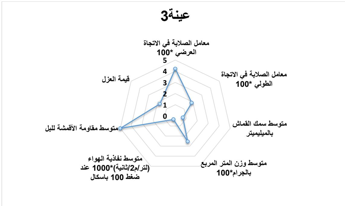
شكل (15-3) يوضح نتيجة اختبار أفضل عينة للعينة رقم (3)
