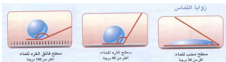
شكل (7) - يوضح زوايا التماس لكريات المياه مع السطح - حين ينتشر الماء على السطوح المحبة للماء hydrophilic تكون منطقة التماس أكبر ما يمكن، وتكون زاوية التماس (عند تلاقي سطح النقيطة مع سطح المادة) في السطوح المحبة للماء أقل من 30 درجة، في حين يكون في السطح الكاره للماء زاوية تماس تزيد على 90 درجة. أما السطح فائق الكره للماء فتزيد زاوية التماس على 150 درجة، حيث يشكل الماء عليه نقيطات كروية الشكل تقريباً ذات سطح تماس صغير جداً تتدحرج عليه بسهولة (20) .
