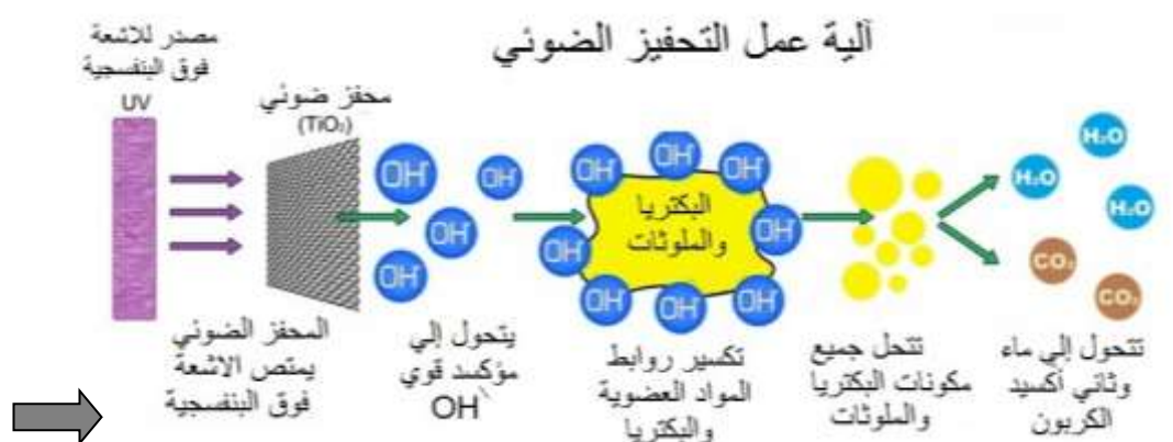
شكل (6)- يوضح آلية عملية التحفيز الضوئي لثاني أكسيد التيتانيوم TiO_2 - حيث يعطي مركب مؤكسد قوي جداً يعمل على كسر روابط المواد العضوية السامة والبكتيريا عند تعرضه لضوء الشمس أو الضوء العادي ويحولها إلى ثاني أكسيد الكربون وماء كما هو موضح في الشكل (24) .
