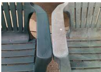
صورة (11) - توضح أثر الأشعة فوق بنفسجية علي اللدائن ( البلاستيك ) في المقعد علي يمين الصورة- مقارنة بالمقعد علي اليسار الذي يوضح أصل وحالة الخامة قبل تعرضها لأشعة الشمس .
