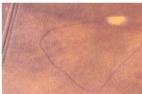
صورة ( 22 ) - تلف سطح الجلد وفقدان لونه - بقعة افتح في اللون نتيجة محاولة إزالة آثار الحبر باستخدام مزيل طلاء الأظافر / الاستيون .
