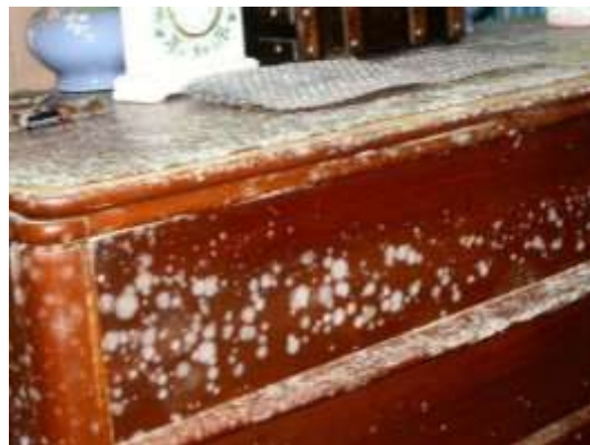
صورة (4) – توضح تعفن الخشب
