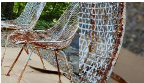
صورة (13) - توضح صدأ الأثاث المعدني نتيجة للرطوبة
