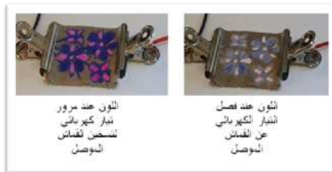
شكل (6) يوضح تغير لون الطباعة الترموكمروميك بمرور تيار كهربائي لتسخين القماش الموصل المطبوع عليه (10).
