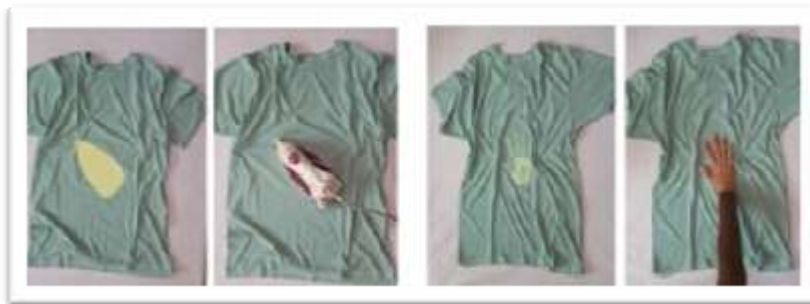
شكل رقم (9) يوضح تأثير درجة الحرارة علي الملابس المعالج بالصبغة الكروموترومحرارية.
