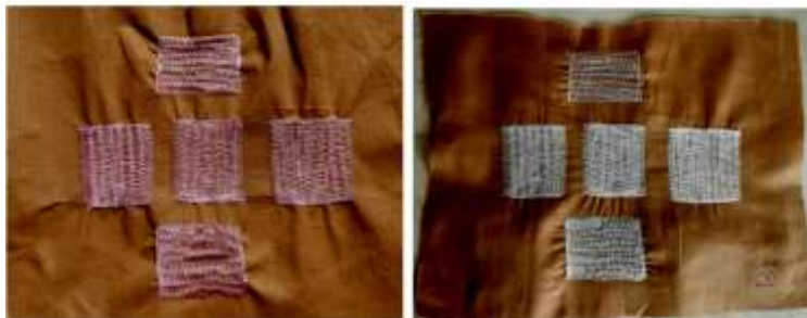
شكل رقم (10) يوضح تأثير أشعة الشمس علي خيط التطريز المعالج بالصبغة الكروموضونية.
