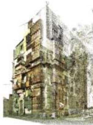
شكل 14: النقاط السحابية المنتجة من المساحات (Baik, boehm, & Robson, 2013)
