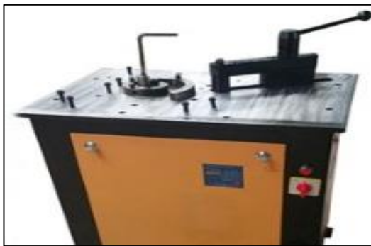
شكل رقم (10) ماكينة وقوالب الحنى الآلي المستخدمة في تشكيل الوحدات الحلزونية
