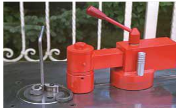
شكل رقم (10) ماكينة وقوالب الحنى الآلي المستخدمة في تشكيل الوحدات الحلزونية
